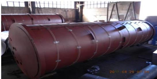
Емкость подземная дренажная используется на нефтеперерабатывающих заводах, и предприятиях по добыче и переработке газа. Применяется для сбора различных технических жидкостей, сточных вод, воды и нефтепродуктов.
